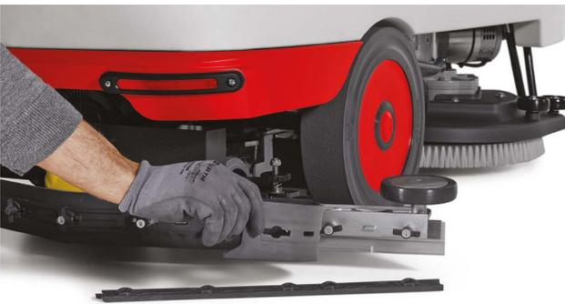
无需使用工具即可轻松更换吸水扒胶条。
