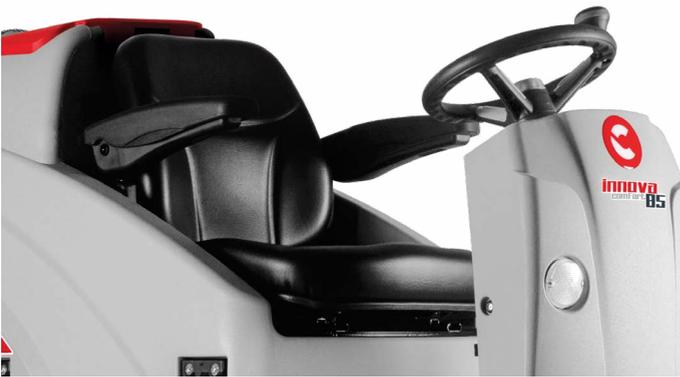
驾驶位置发生了颠覆性的变化。方向盘的倾斜角度和带有扶手的舒适座椅可以确保操作人员享有很高的舒适度，即使工作的时间加长，也不会感到疲劳。此外，驾驶位置为操作人员提供了更好的视野，有利于专心操控洗地机所有功能。
